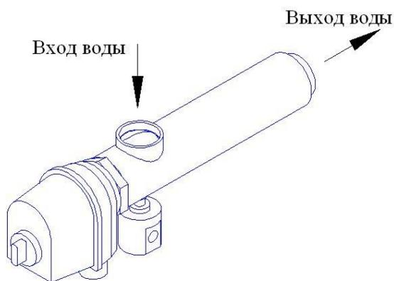
Основной задачей электронагревателя является подогрев воды. Электронагреватель компенсирует теплотери при восполнении объема свежей подпиточной водой и потерь, возникающих при её испарении с поверхности зеркала воды, в коммуникациях и оборудовании системы оборотного водоснабжения.
