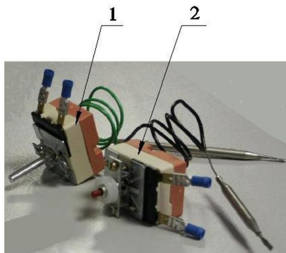
Принцип действия датчика основан на температурном расширении жидкости. При нагревании жидкости в колбе, избыточное давление через капиллярную трубку передается мембране, которая, деформируясь, размыкает контактную группу. Температура размыкания составляет 60°C. Возврат контактной группы в исходное положение после остывания жидкости, осуществляется нажатием на специальную кнопку возврата.
