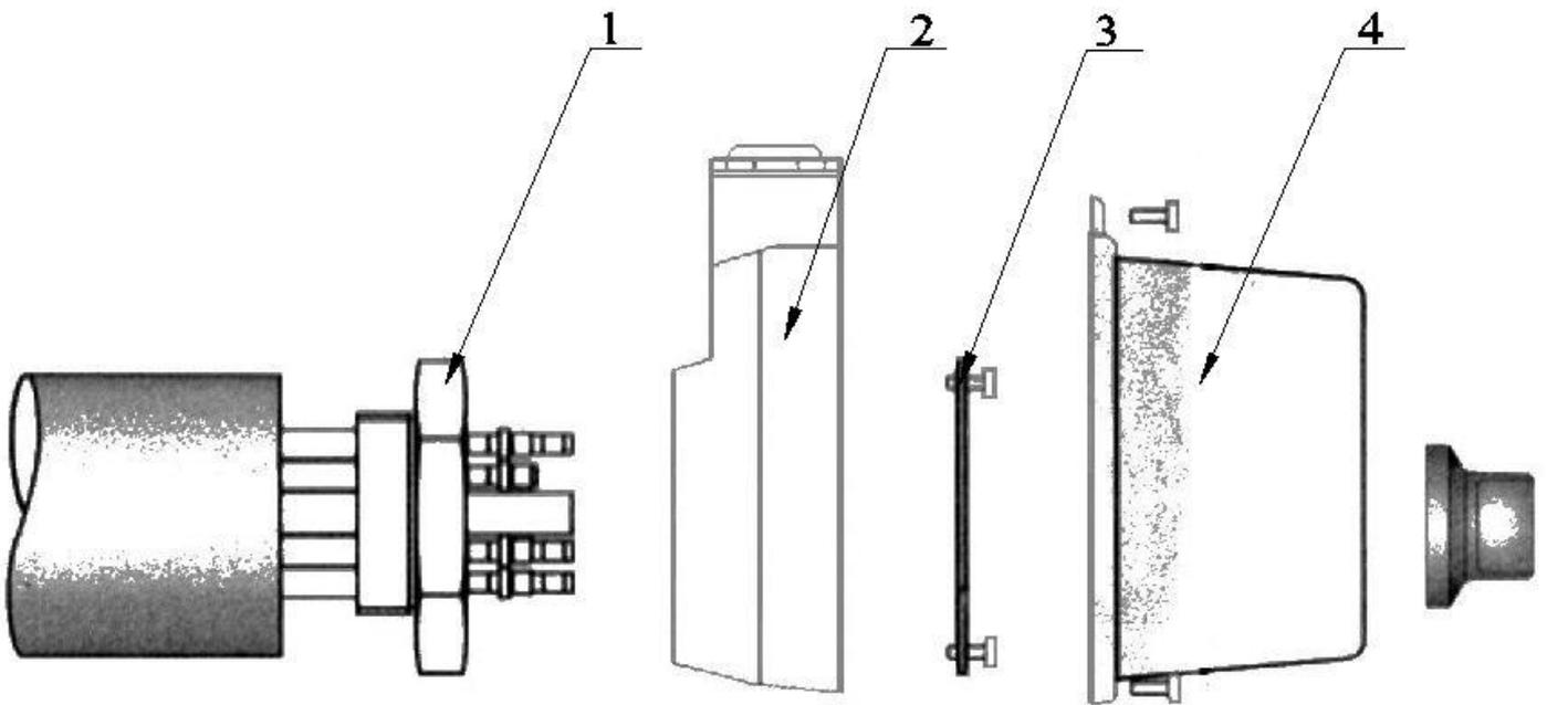
2. При помощи прижимного кольца соедините крышку заднюю (поз.2, рис.8) с ТЭНом (поз.1, рис.8).
