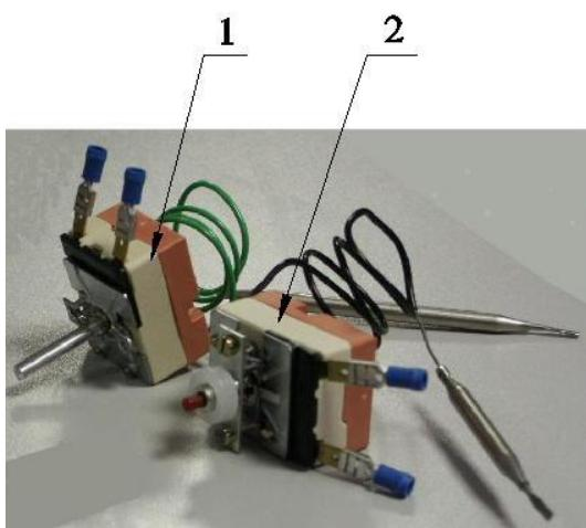
Датчик перегрева представляет собой резервуар с жидкостью (колба), соединенный с механическим реле при помощи капиллярной трубки, которая заканчивается подвижной мембраной.
